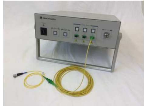
ノイズ検出用光プローブ(V センサ)
