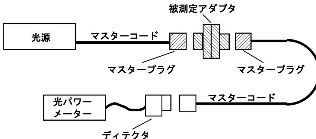
図 1. 挿入損失測定系
